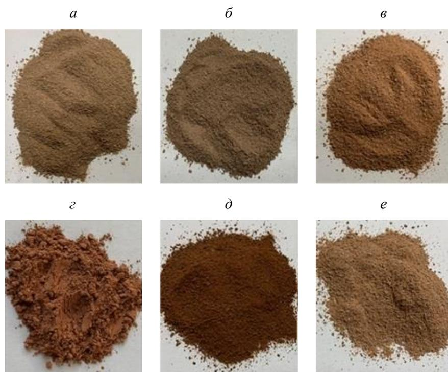
Рис. 1. Внешний вид композитов: *a* — Sap; *б* — Sap<sub>эхо</sub>; *в, г* — Sap после обжига 400 (Sap<sub>400</sub>) и 625 °C (Sap<sub>625</sub>); *д* — Fe-Sap<sub>400</sub>; *е* — Al-Sap<sub>400</sub>
