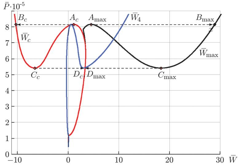
Рис. 2. Зависимость нагрузки  $\bar{P}$  от прогиба  $\bar{W}$  для цилиндрической панели 3 из углепластика марки Т300/976:
