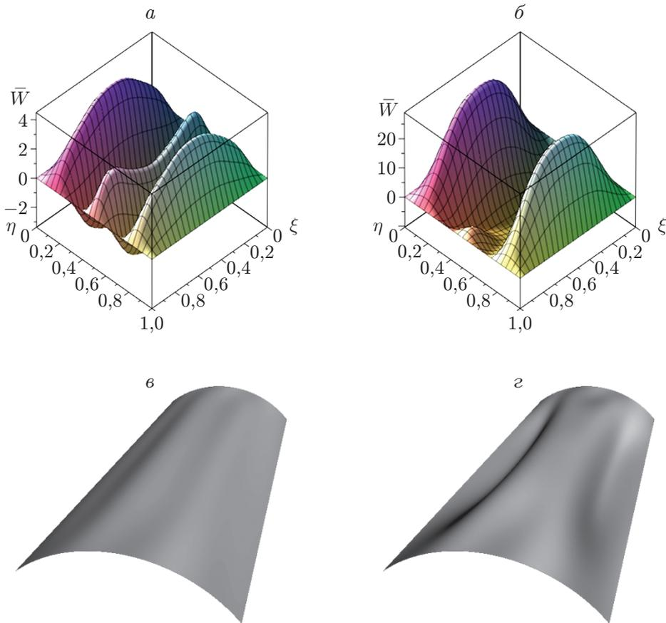
Рис. 3. Прогибы до (а, в) и после (б, г) потери устойчивости при нагрузке  $\bar{P}_{cr} = 8,15 \cdot 10^5$  ( $q_{cr} = 0,007134$  МПа), отсчитываемые от опорной плоскости (а, б) и от поверхности оболочки (в, г)
