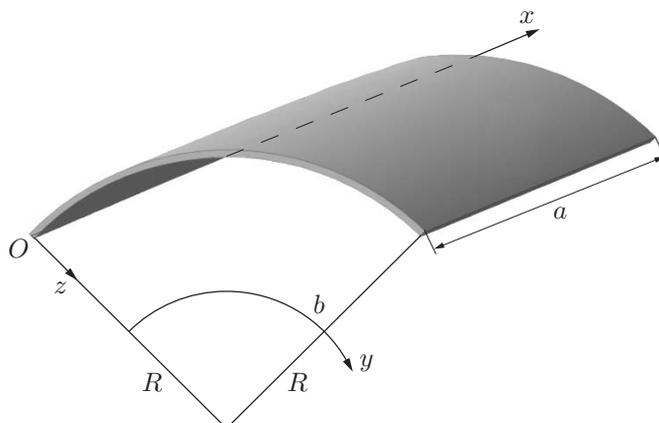
Рис. 1. Цилиндрическая панель
