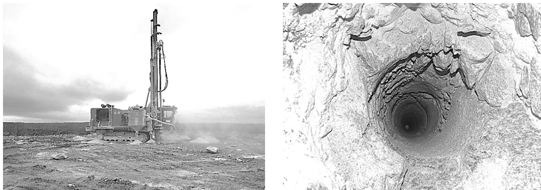
Рис. 13. Скважина, пробуренная пневмоударником П170 на станке SWDB165
