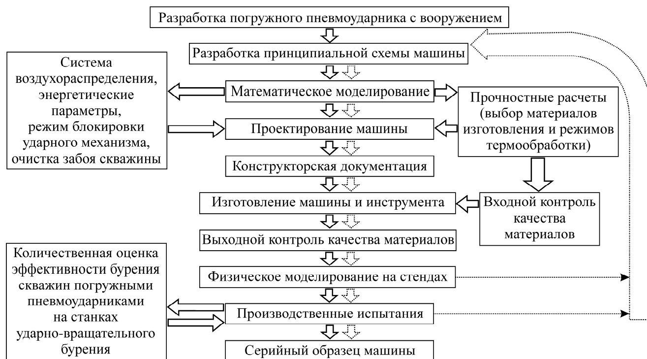
Рис. 1. Схема повышения эффективности ударно-вращательного бурения скважин погружными пневмударниками
