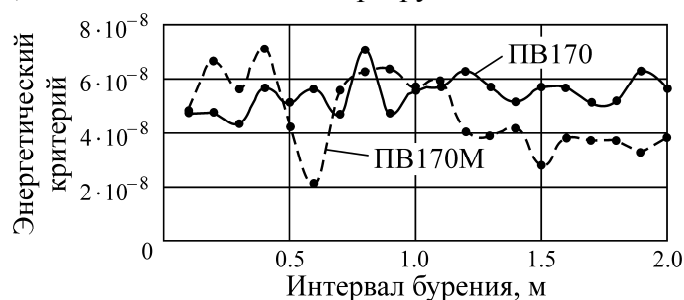
Рис. 14. Изменения критериального показателя k с глубиной поинтервального бурения гранитных пород (карьер “Борок”)
