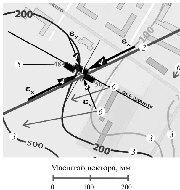
Рис. 5. Фрагмент участка г. Нижний Тагил и его структурно-деформационная характеристика: 1 — здание; 2 — сбросо-сдвиг “Средний”; 3 — изолинии оседаний поверхности; 4 — направление действий главных деформаций; 5 — номер и расположение деформационных марок в здании; 6 — векторы сдвижения горных пород в районе исследуемого здания
