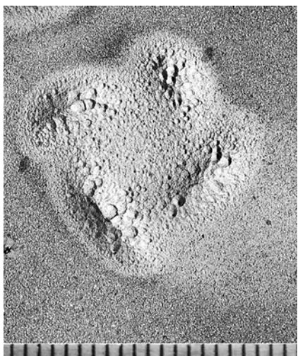
Рис. 8. Форма пятна напыления для закрученной струи сопла со щелевой проницаемостью в виде четырех щелей.
