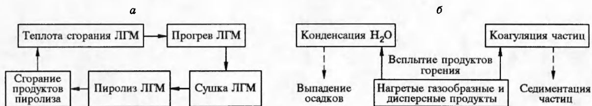
Рис. 2. Схема физико-химических процессов во фронте лесного пожара (а) и в приземном слое атмосферы (б)
