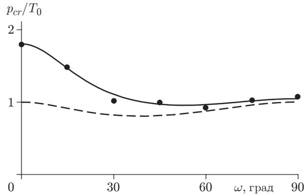
Рис. 4. Зависимость критического давления от угла наклона отверстия: точки — экспериментальные данные, сплошная линия — результаты расчета по формуле (8), штриховая — результаты расчета при  $\rho_{cr} = 0$
