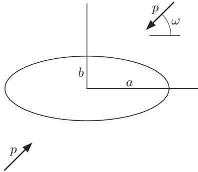
Рис. 1. Эллиптическое отверстие при сжатии
