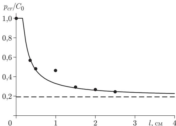
Рис. 3. Зависимость критического давления от диаметра отверстия: точки — экспериментальные данные, сплошная линия — результаты расчета по формуле (5), штриховая — результаты расчета при  $L_{cr} = 0$
