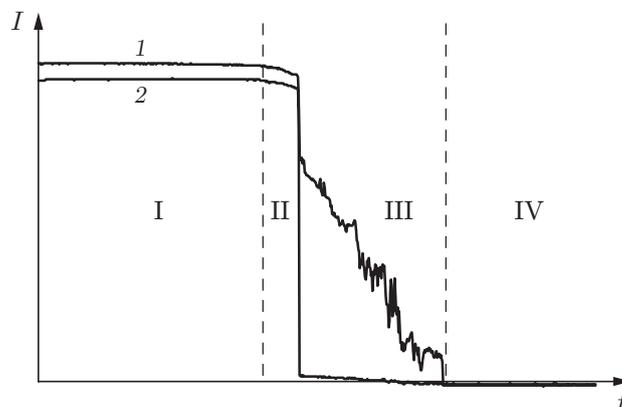
Рис. 2. Диаграммы ЭП при образовании трещин отрыва:
