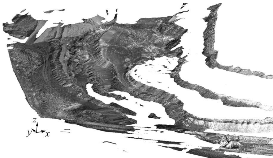
Рис. 2. Модель участка отвала со “слепыми” (светлыми) зонами, построенная с применением данных наземного лазерного сканирования
