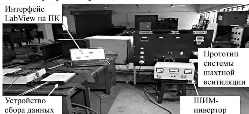
Рис. 1. Экспериментальная установка для проверки блока оценки скорости системы вентиляции на основе АСУЭМ
