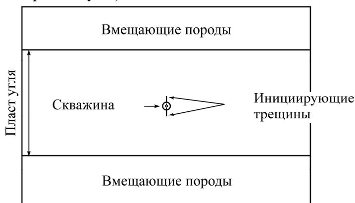
Рис. 1. Двумерная модель среды, содержащей угольный пласт и скважину с двумя вертикальными щелевыми инициаторами, пробуренную в направлении главного напряжения
