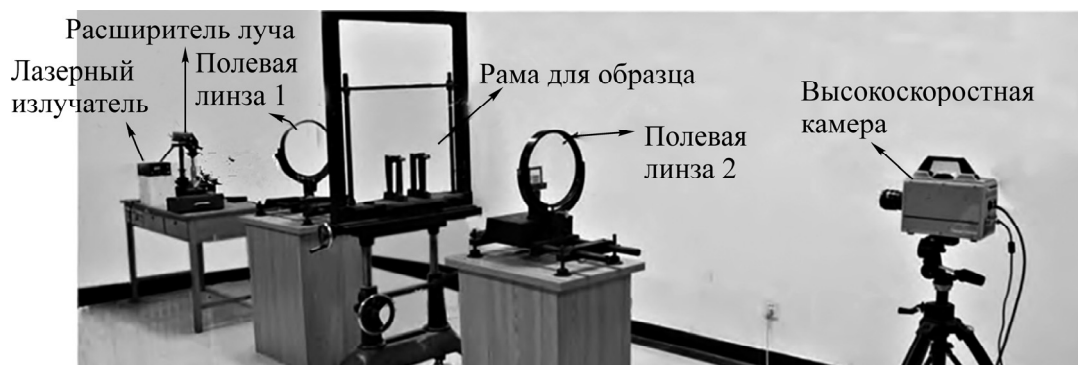
Рис. 1. Установка для исследования развития трещины методом каустик
