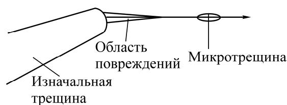
Рис. 8. Развитие изначальной трещины и ее проникновение в область микротрещин
