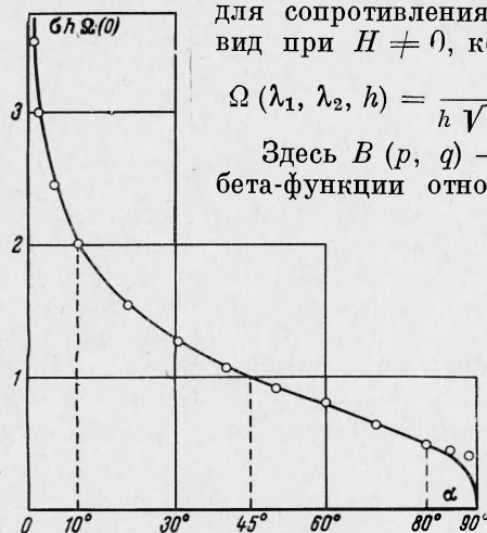
Фиг. 2. Зависимость h\sigma\Omega(0) от угла \alpha . Кругами указаны экспериментальные данные. Расчетные данные, полученные по формуле (2.9), нанесены сплошной линией
