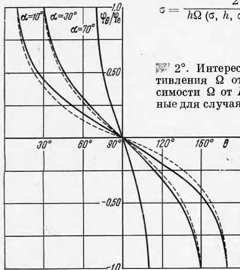
Фиг. 4. Распределение электрических потенциалов по окружности диска при H=0 , для \alpha = 10, 30 и 70^\circ , вычисленные по формулам (2.15), — сплошные линии. Пунктирными линиями изображены результаты соответствующих экспериментов
