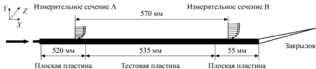
Рис. 2. Схема экспериментальной конфигурации для исследования течения на структурированной пластине.
