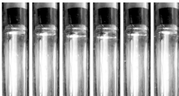
Рис. 3. Рост и уменьшение паровой пробки в канале
