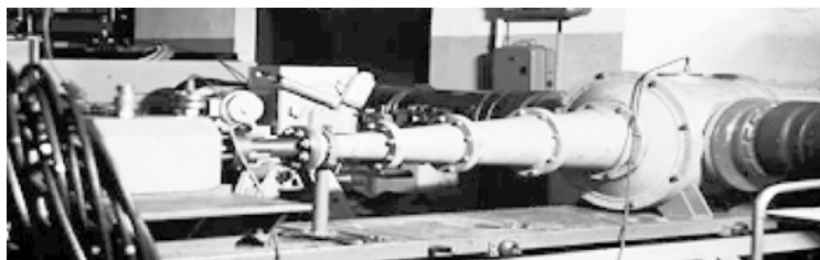
Общий вид и схема импульсной аэродинамической трубы ИТ-301.
