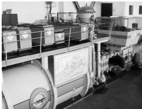
Сверхзвуковая аэродинамическая труба Т-313 ( M = 1,75 \div 7 ).
