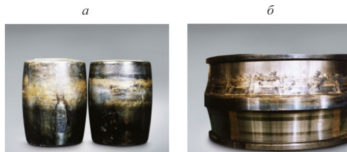
Рис. 7. Дефект двухрядного подшипника качения: а — износ тел качения; б — износ беговой дорожки
