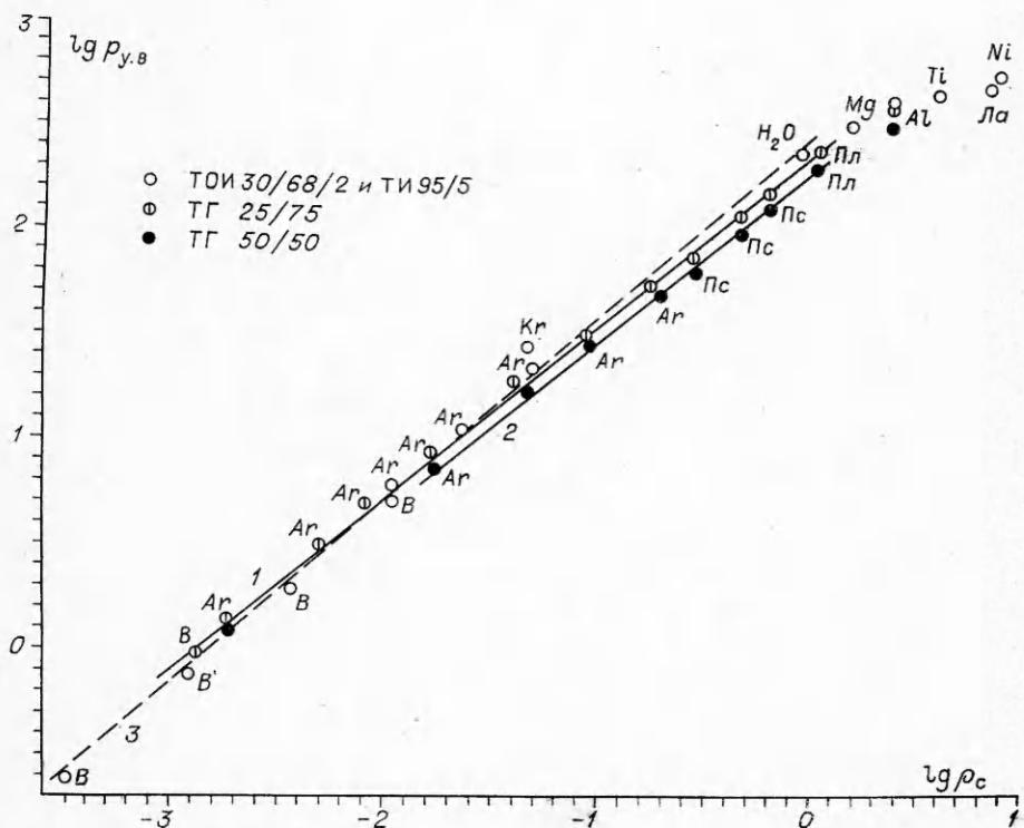
Имеется немало экспериментов подобного типа, в которых измерены параметры детонационной и ударной волн. Обработка экспериментов по взрыву смесей тротил — гексоген (ТГ) [1] и тротил — октоген — инерт (ТОИ) [2] выявила интересную закономерность.
