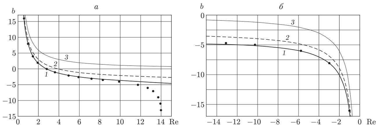
Рис. 2. Зависимости параметра  $b$  от числа Рейнольдса для случаев увеличения ( $Re > 0$ ) (а) и уменьшения ( $Re < 0$ ) (б) расстояния между пластинами: точки — точные численные решения [5]; 1 — разложение по числу Рейнольдса при  $a = 2$ ; 2 — разложение по числу Рейнольдса при  $a = 1$ ; 3 — главная асимптотика  $b = 12/Re$
