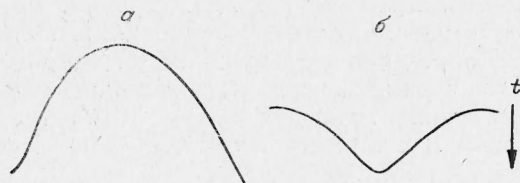
Рис. 3. Фотохронограммы фронта ударной волны, полученные методом вспыхивающего воздушного зазора в щелевом режиме.
