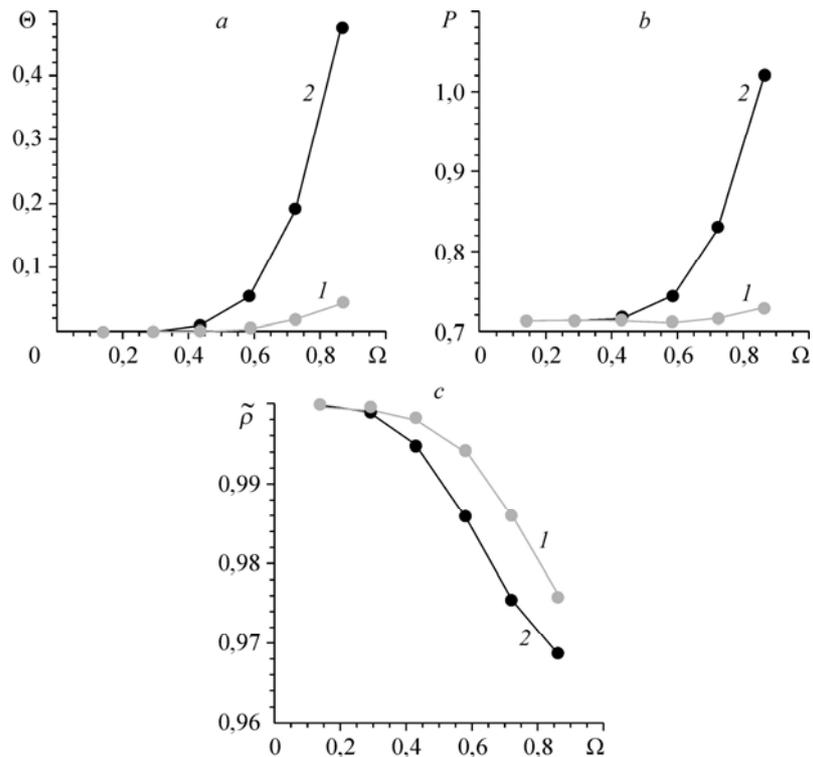
Рис. 11. Максимальные по области значения средних за период температуры (а) и давления (b) и минимальные по области значения средней за период плотности (с) в зависимости от частоты вибрации при  $\tau \approx 500$ .
