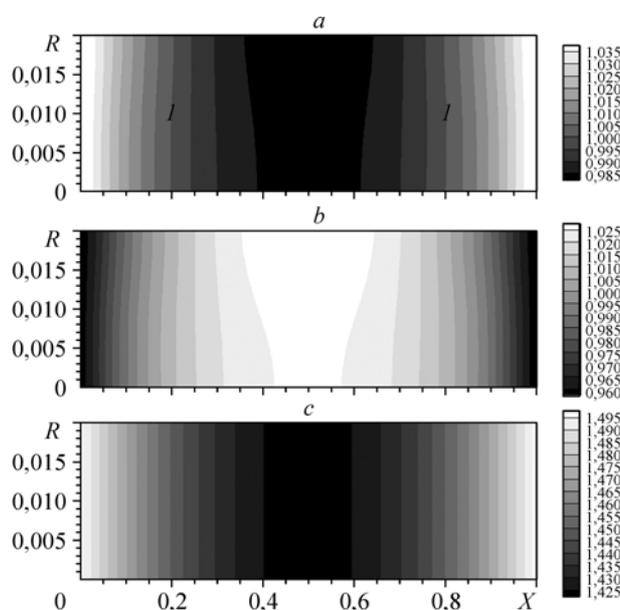
Рис. 10. Средние за период распределения плотности (а), температуры (b) и давления (с) при  $\Omega = 0,86$ ,  $\tau \approx 1900$ .
