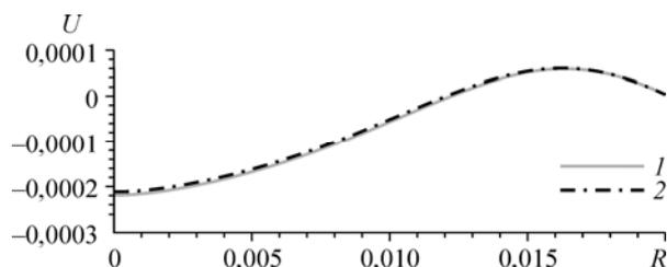
Рис. 5. Распределения скорости  $U$  вдоль радиуса при  $X = 0,5$ ,  $\tau = 110$ ,  $\Omega = 0,14$ .
