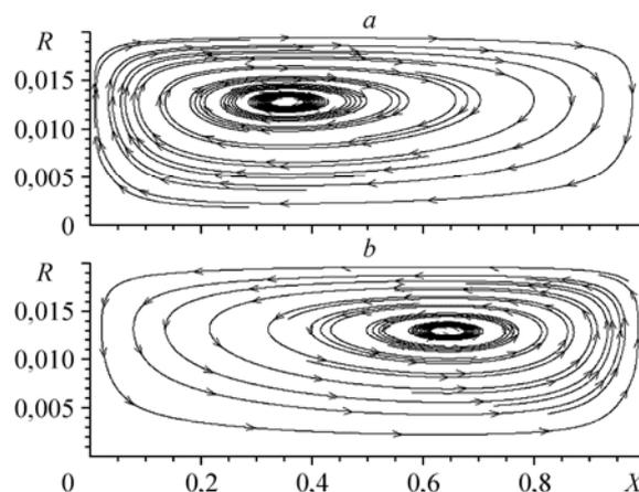
Рис. 12. Линии тока в моменты наибольшего отклонения полости от положения равновесия при  $\Omega = 0,86$ .  $\tau = 1902$  (а),  $1905,6$  (b).
