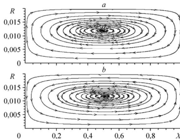
Рис. 4. Линии тока в моменты наибольшего отклонения полости от положения равновесия при  $\Omega = 0,14$ .
