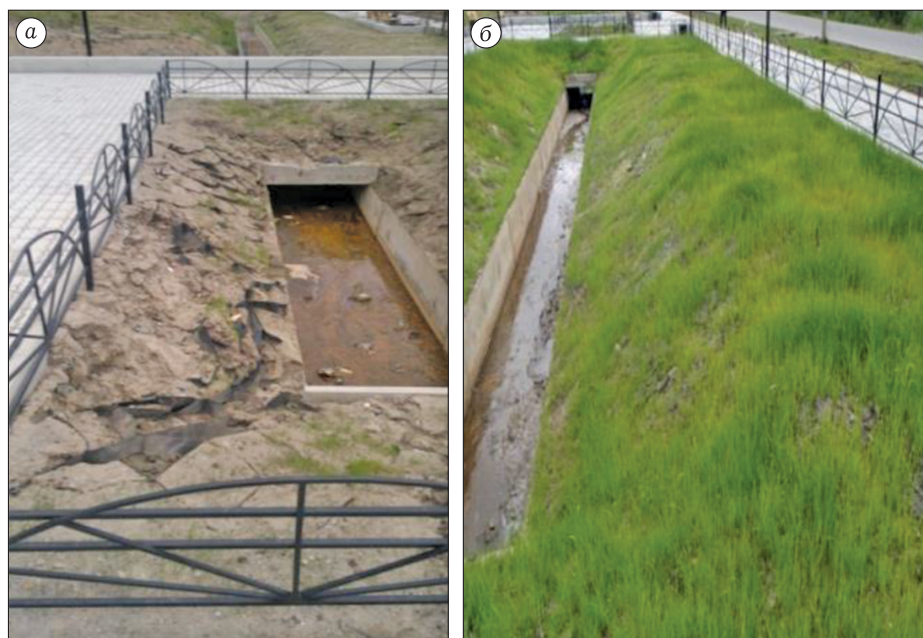
Рис. 5. Закрепление откосов, разрушенных после зимнего периода: а – контрольный участок (не обработанный криогелем); б – опытный участок, закрепленный криогелем.
