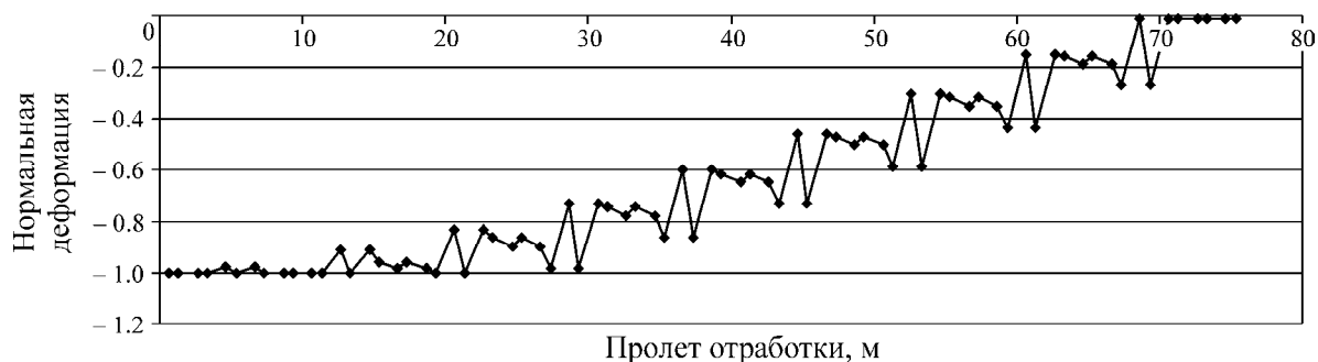
Рис. 6. Изменение нормальной к плоскости пласта деформации в элементах, моделирующих неполноту заполнения выработанного пространства закладочным материалом, вдоль оси Ox при пролете отработки 70 м
