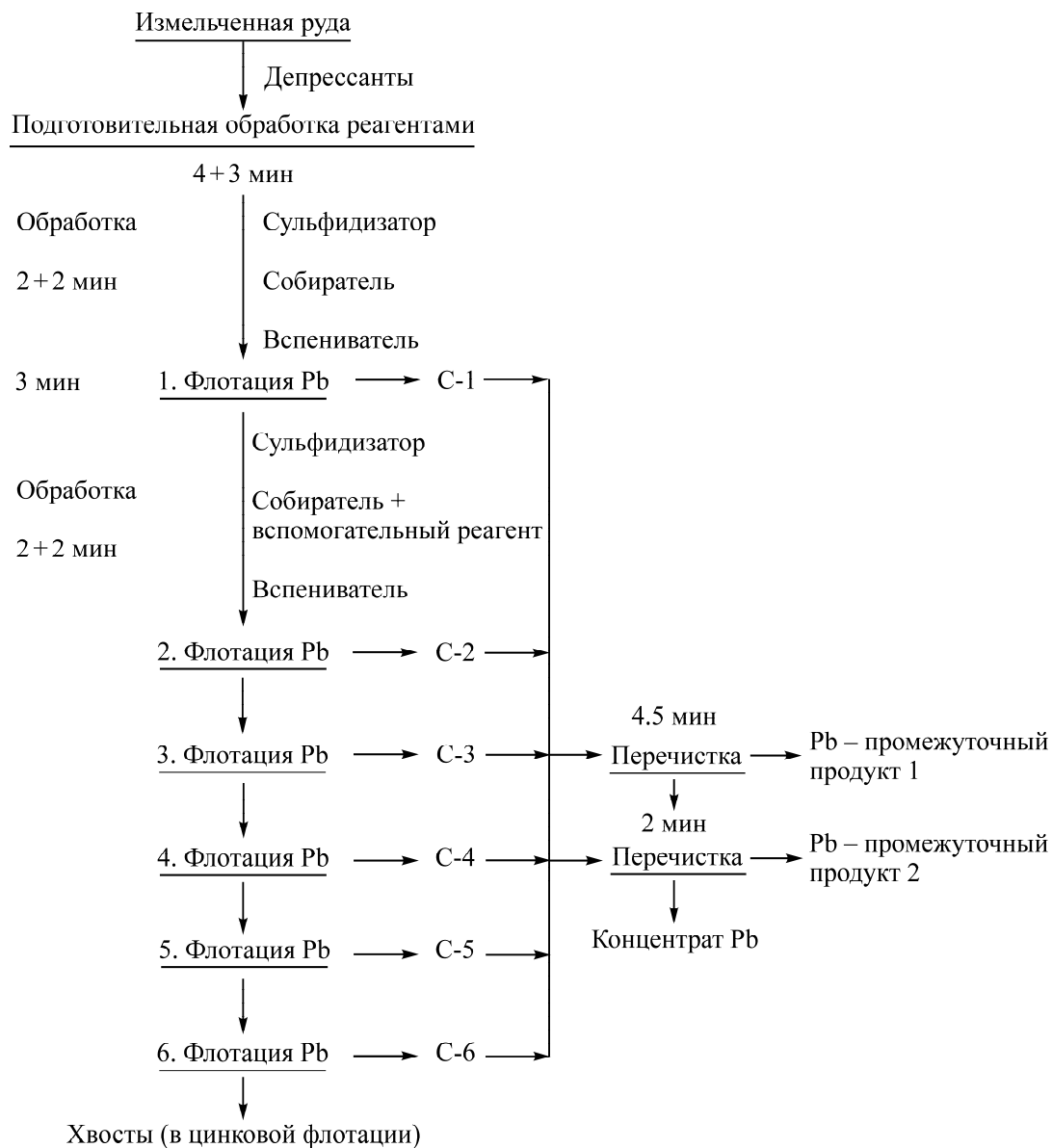
Рис. 2. Экспериментальная схема флотации Pb и Zn
