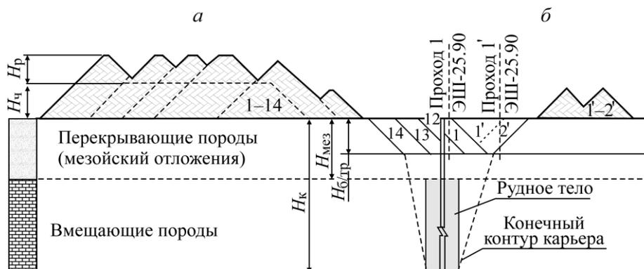
Рис. 4. Схемы бестранспортной отработки верхнего горизонта покрывающих пород на крутопадающих месторождениях
