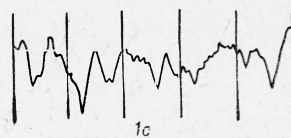
Рис. 1. Осциллограмма пульсаций давления; p=20 атм, d_2=200 \div 250 мкм.
