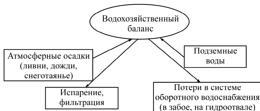
Рис. 2. Схема водохозяйственного баланса разреза Урюпский
