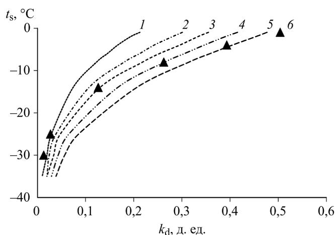
Доля диффузии водяного пара в коэффициенте теплопроводности снега ( $k_d$ ), рассчитанная по формуле (10), при  $\lambda_c = \lambda_{cp}$  при разной температуре снега ( $t_s$ ) плотностью, кг/м<sup>3</sup>: 1 — 400; 2 — 300; 3 — 250; 4 — 200; 5 — 150; 6 — по формуле Павлова (4).
