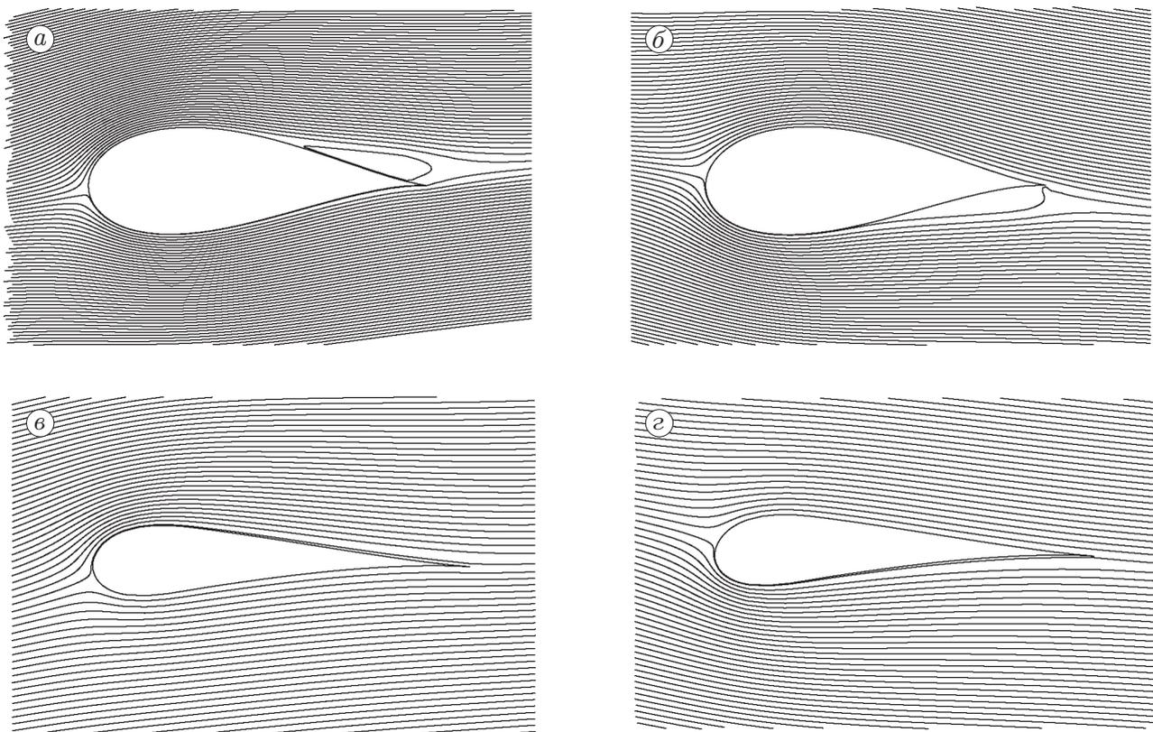
Рис. 4. Картины обтекания исходного ( $a, б$ ) и модифицированного ( $в, г$ ) контуров профиля Жуковского, полученные с использованием пакета программ “Fluent”:
