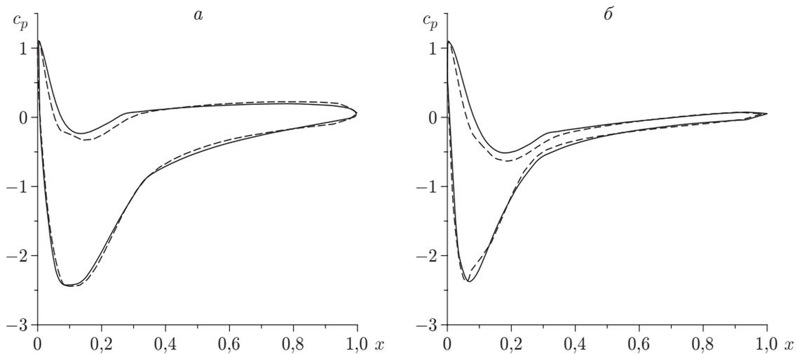
Рис. 3. Распределение коэффициента давления на контуре модифицированного профиля Жуковского, полученное численно (сплошные линии) и с использованием пакета программ “Fluent” (штриховые линии):
