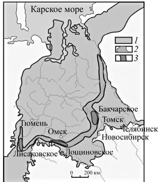
Рис. 2. Схема Западно-Сибирского железорудного бассейна: 1 — площадь распространения мел-палеогенового моря; 2 — полоса распространения прибрежно-морских железорудных отложений; 3 — площади наиболее крупных железорудных узлов (месторождений)
