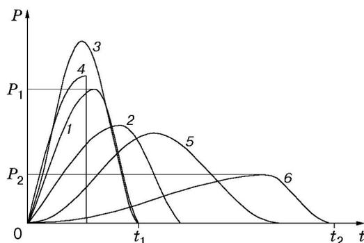
Рис. 1. Зависимость  $P(t)$  при  $V_0 = 0,5$  м/с ( $P_1 = 4470,14$  Н,  $P_2 = 1609,58$  Н,  $2\gamma = 150^\circ$ ,  $t_1 = 0,000\,253\,164\,7$  с,  $t_2 = 0,000\,699\,146\,8$  с):
