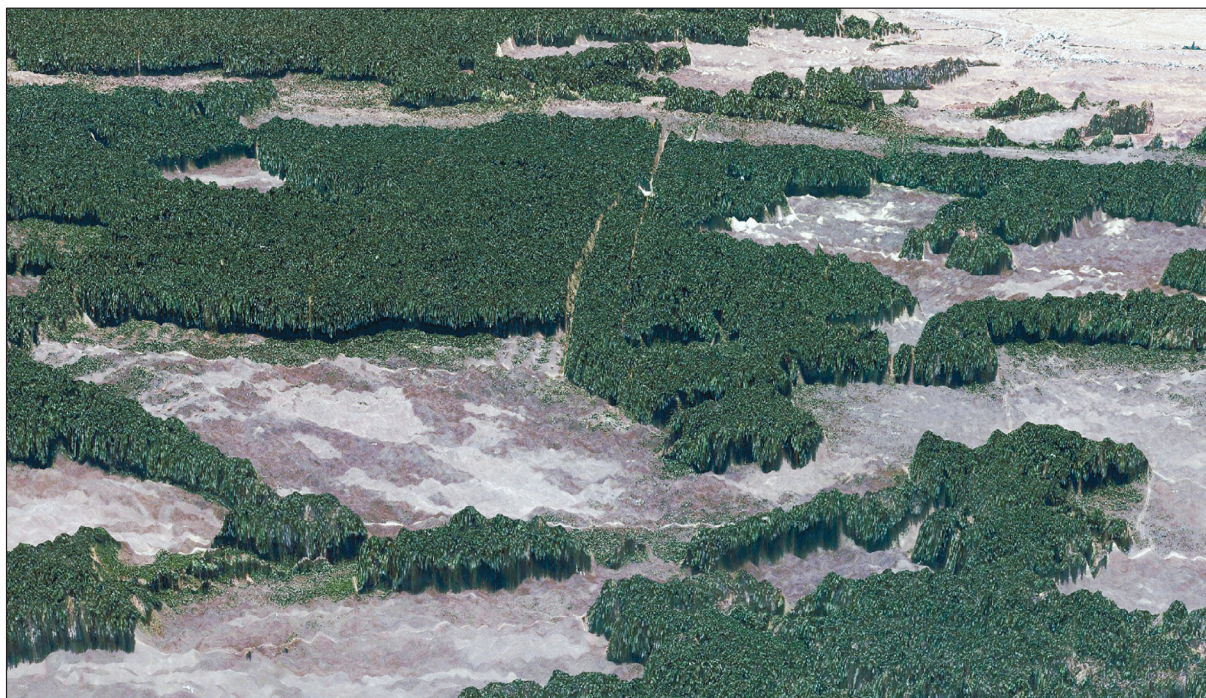
Рис. 1. Псевдоцветовое трехмерное отображение фрагмента цифровой модели средней высоты деревьев, полученной по тандемной паре радарных снимков TerraSAR-X/TanDEM-X от 18.02.2012.
