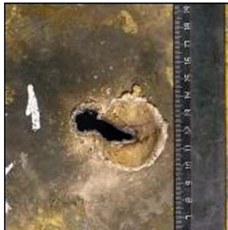
Рис. 6. Входное отверстие от кумулятивной струи в верхнем диске наборной преграды, полученное в одном из опытов при разнотолщинности полусферической облицовки 2.5 \text{ мм}/0.7 \text{ мм}
