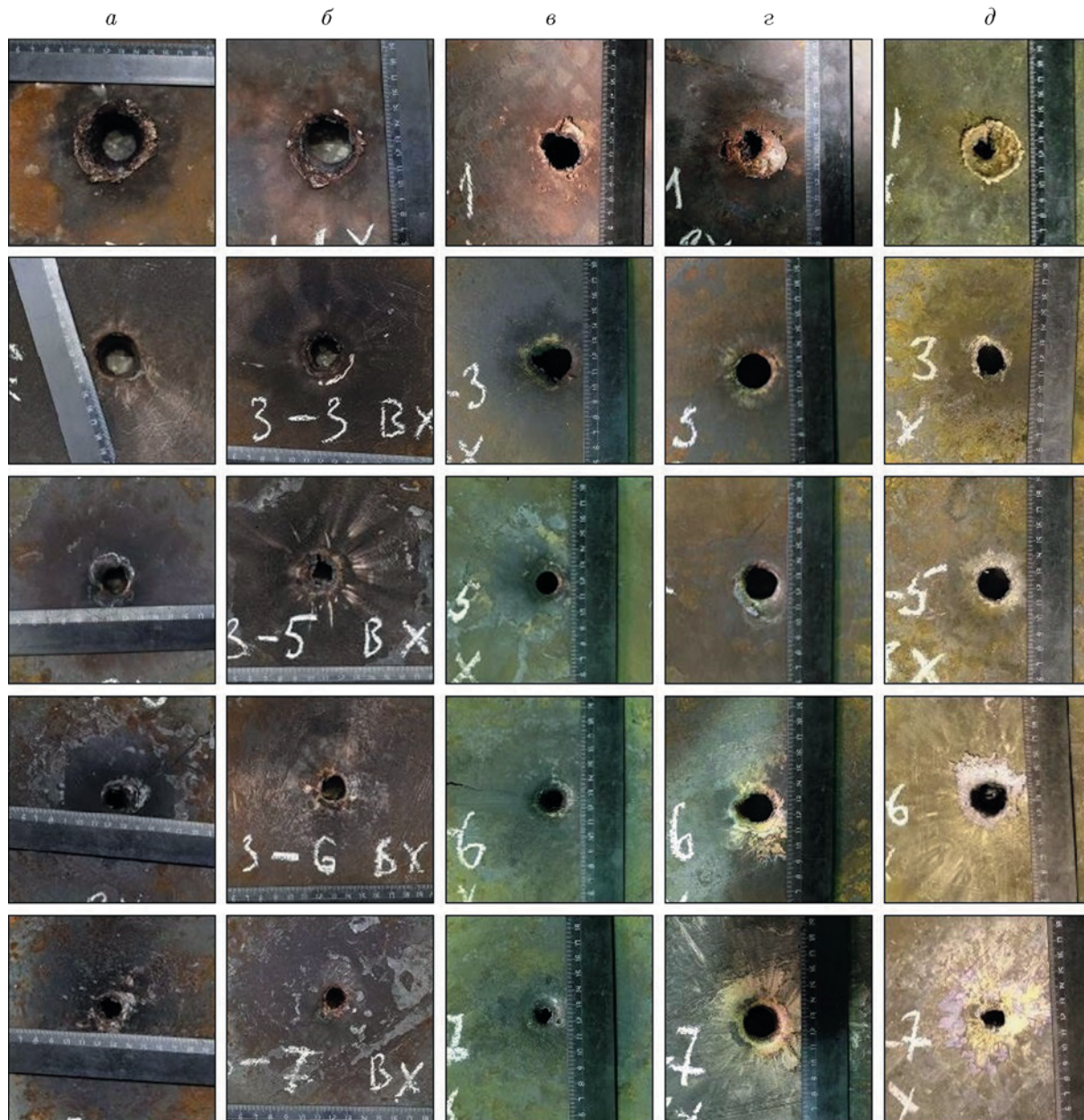
Рис. 7. Входные отверстия в 1, 3, 5, 6 и 7-м (сверху вниз) стальных дисках наборной преграды, полученные от кумулятивных струй из полусферических облицовок с различным соотношением толщин в вершине и у основания:
