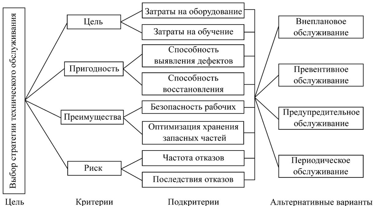
Рис. 3. Иерархическая структура выбора стратегии технического обслуживания
