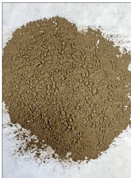
Рис. 2. Сорбент, полученный путем прокаливания золошлаковых отходов предприятий теплоэнергетики.
