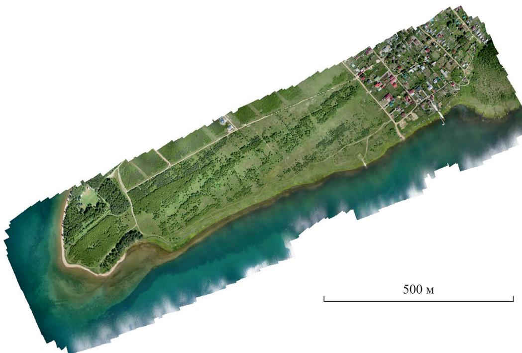
Рис. 3. Ортофотоплан фрагмента местности в районе Иркутского водохранилища, съемка БПЛА с высоты 220 м.
