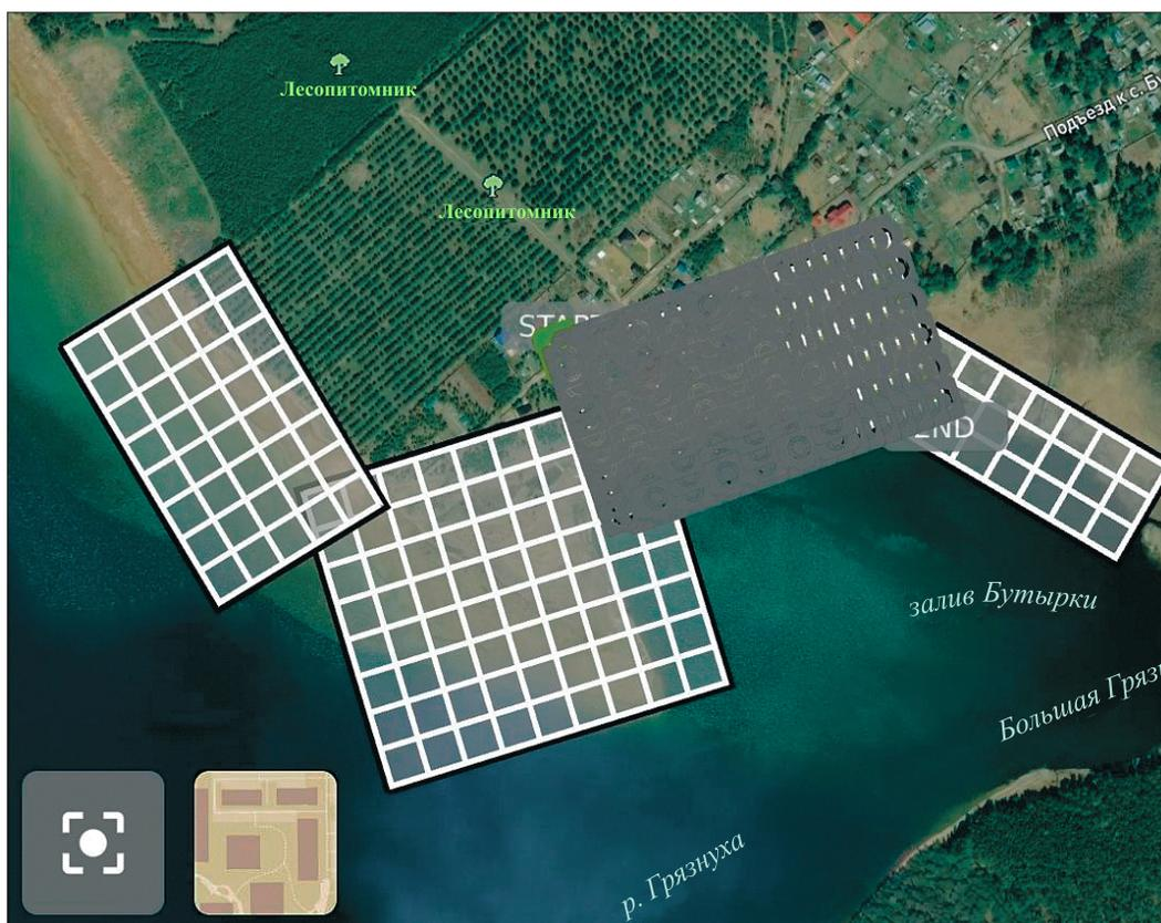
Рис. 2. Полетные планы (схема) съемки ключевого участка (фрагмент Иркутского водохранилища) при помощи БПЛА DJI Mavic 2 Pro с высоты 100 м в интерфейсе программы Pix4Dcapture.
