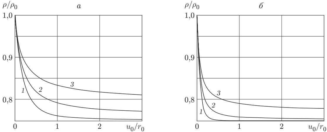
Рис. 1. Зависимость плотности среды вблизи внутренней поверхности от радиального перемещения ( $\rho_* = 0,75\rho_0$ ):
