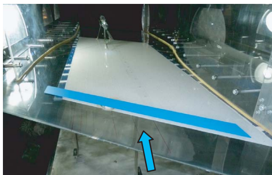
Рис. 4. Полоса шероховатости W1H2, наклеенная на пластину (стрелка — направление набегающего потока)
