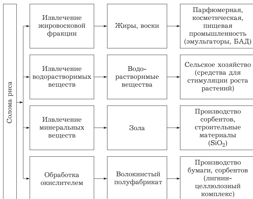
Рис. 2. Принципиальная схема ресурсосберегающей переработки соломы риса. Информация адаптирована из [13].
