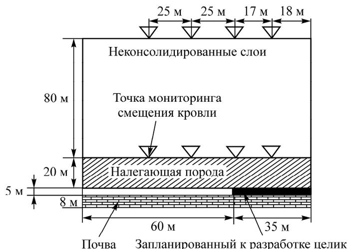
Рис. 3. Расположение точек мониторинга давления и смещений
