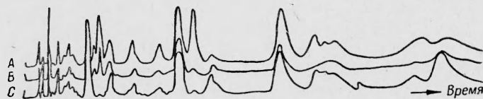
Рис. 7. Газохроматографическое разделение продуктов холодного окисления смеси 2-метилпентана с кислородом [25]. А — продукты из двигателя; В — продукты из машины адиабатического сжатия; С — продукты из сферического стеклянного реактора.
