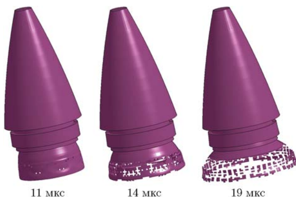
Рис. 10. Схема оболочки и формирование осколков
