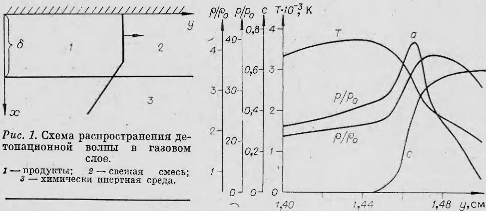
Рис. 1. Схема распространения детонационной волны в газовом слое.
