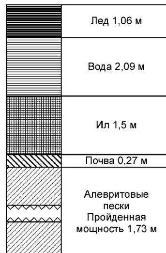
**Рис. 2. Разрез буровой колонки № 6.**
