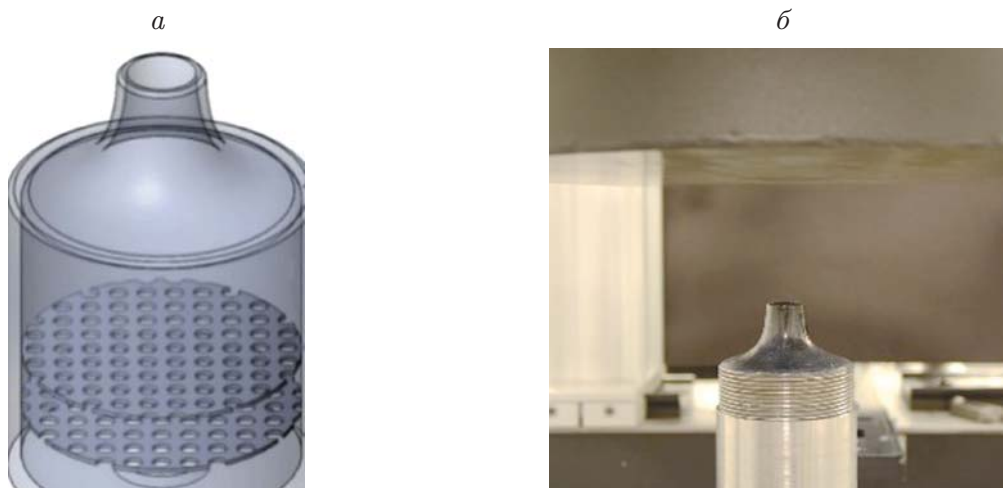
Рис. 1. Схема сопла с лопастным завихрителем внутри (а) и фотография сопла и импактной поверхности (б)
