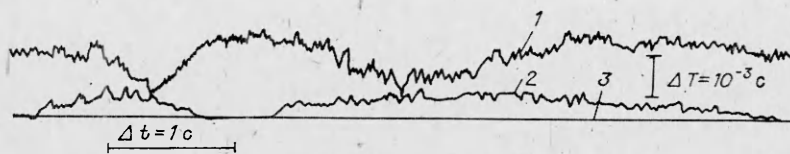
Рис. 4. Осциллограмма эффективного времени сгорания T(t) (1) и случайных колебаний интенсивности излучения I(t) (2). 3 — линия нулевого отсчета I(t) .
