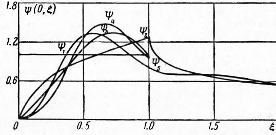
Фиг. 4. Зависимость температуры поверхности от времени для разных тепловых потоков
