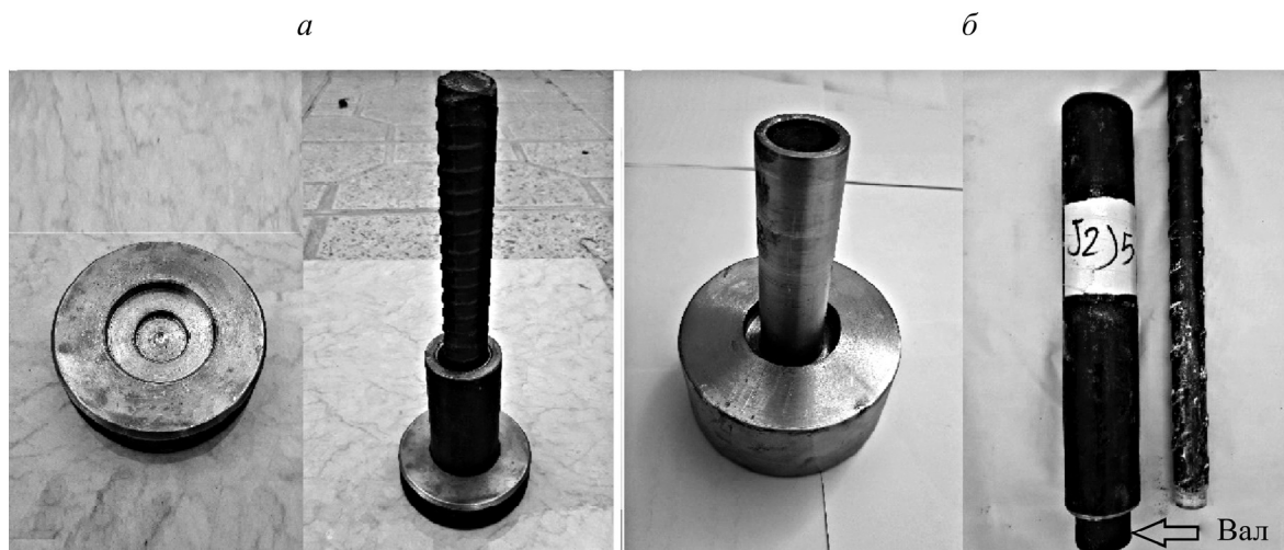
Рис. 3. Подготовленные для испытаний образы анкеров с полимерной цементацией при длине анкеровки 75 мм (а) и 150 мм (б)
