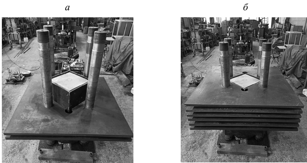
Рис. 1. Общий вид образца в испытательной камере до укладки стальных листов (а) и после (б)
