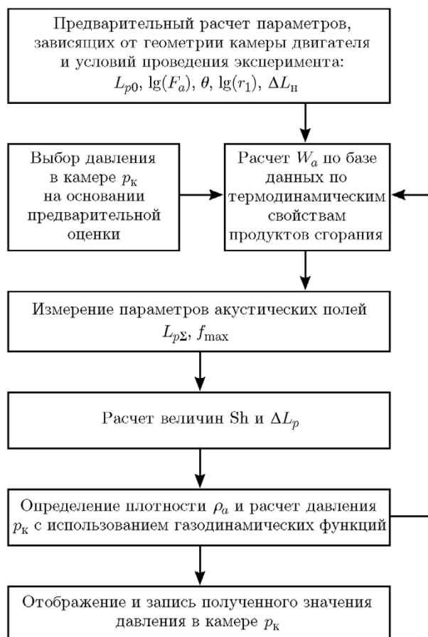
Рис. 8. Блок-схема измерения давления в камере РДТТ по результатам акустической диагностики
