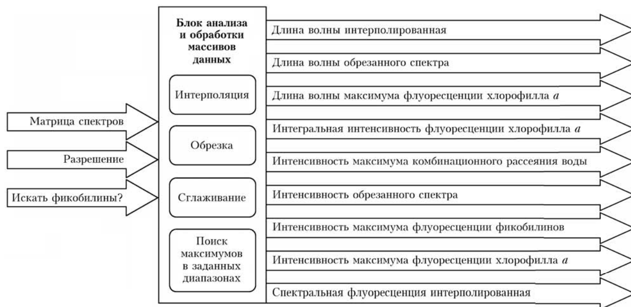
Рис. 3. Структура входной и выходной информации блока анализа и обработки полученных массивов данных
